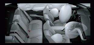
أكياس الهواء: مجهّزة بكيس هواء SRS للسائق وكيس هواء SRS للراكب الأمامي، وأكياس هواء SRS جانبية (المقاعد الأمامية) وأكياس هواء SRS ستائرية واقمة (المقاعد الأمامية والخلفية). ٣٠ ( \*GRANDE HEV/SE/GRANDE/GLE)
